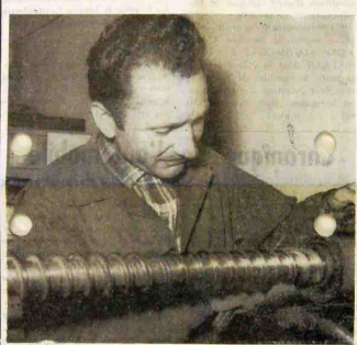
Réparation de la vis à injection de la machine Mausez. M. Roy s'est fait une spécialité de l'entretien et de la réparation de toutes les machines utilisées dans les ateliers de confection.
