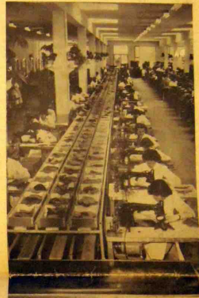
Une perspective du nouveau convoyeur n° 3 avec sa double rangée de glissières superposées.
